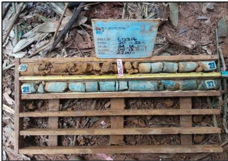
Gambar 6. Hasil Pemboran Kedalaman 22 meter (Sumber: Dokumentasi Lapangan ,2023)
