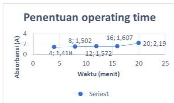
Gambar 4 Spektrum pengukuran operating time kompleks antara kuersetin dengan AlCl_3
