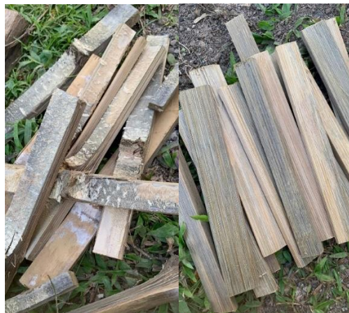
Gambar 2. Bambu Petung yang sudah dibelah (kiri) dan dibersihkan dari kulit dan bagian dalam (kanan)
