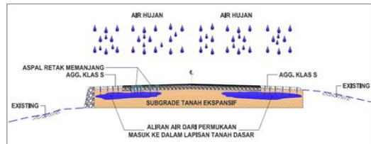
Gambar 7. Ilustrasi proses Infiltrasi pada Tanah Ekspansif
