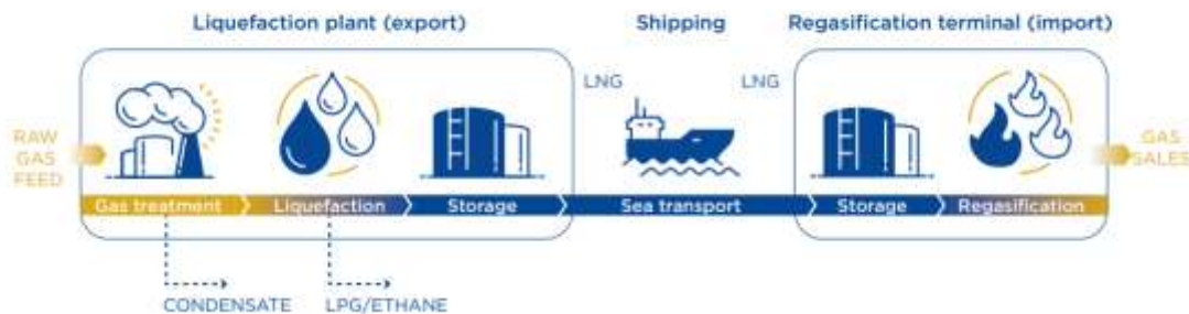
Gambar 1. LNG Process Chain
