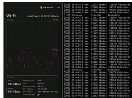
Gambar 16. Pengujian Throughput ZeroTier Sumber: Hasil Tangkapan Layar Peneliti (2026)
